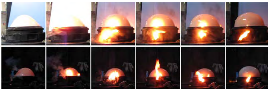
Slika 7: Vpliv vžiga na zajemanje posnetkov za določanje površine steklenega izdelka.
