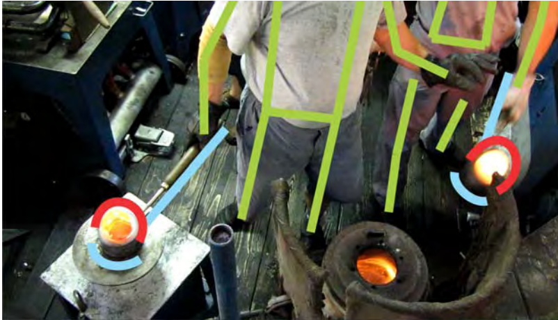
Slika 1: Primer pretežno ročnega steklarskega okolja in ilustracija tipov informacij, ki jih želimo za namen avtomatizacije izluščiti z zajemanjem in obdelavo videoposnetkov.
