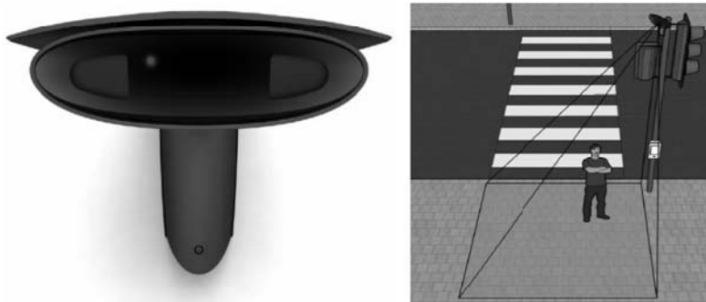
Slika 19: SafeWalk 3D detekcijski senzor in primer namestitve
