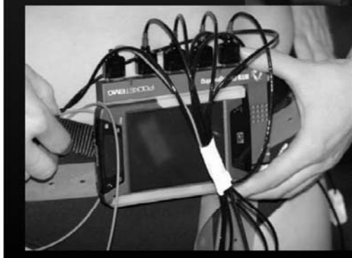
Slika 6: Površinska aplikacija elektrod na posamezne mišične skupine, prenos v stacionarno enoto z surovim in filtriranim EMG signalom.
