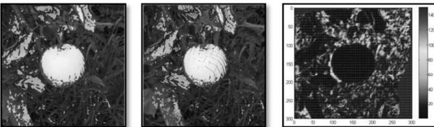
Slika 4: Porazdelitev korespondenčnih točk (sliki levo in na sredini) in ocena ujemanja (slika desno) za par posnetkov s slike 3; čim bolj temno modre so ocene, tem boljše je ujemanje.
