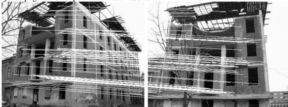
Slika 1: Začetne korespondenčne točke izračunane z metodo ASIFT: na levi sliki pogled prve kamere in na desni sliki pogled druge kamere. Bele črte na sliki prikazujejo povezave med korespondenčnimi točkami.
