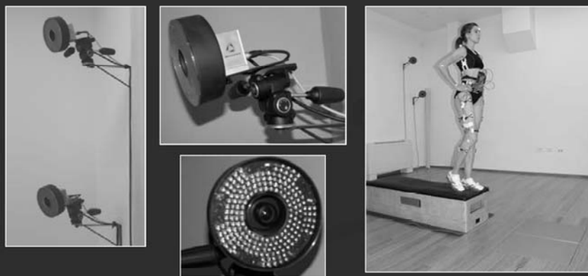
Slika 1. Sistem za 3 D kinematično analizo vertikalnih in globinskih skokov (BTS SMART – 600)
