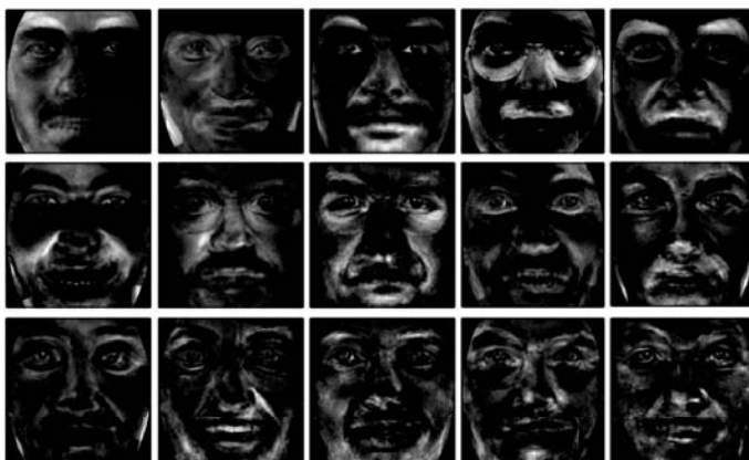
Slika 2: Lastni vektorji, kjer je opazen vpliv osvetlitev na vektorje z višjimi lastnimi vrednostmi (zgornja vrsta), in značilnosti, ki jih predstavljajo (spodnji dve vrsti).
