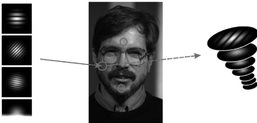
Slika 1: Tvorba vektorja valčnih koeficientov za okolico ključnih točk s pomočjo valčne transformacije z Gaborjevimi valčki, pri čemer so ključne točke izbrane glede na fiziognomijo obrazov
